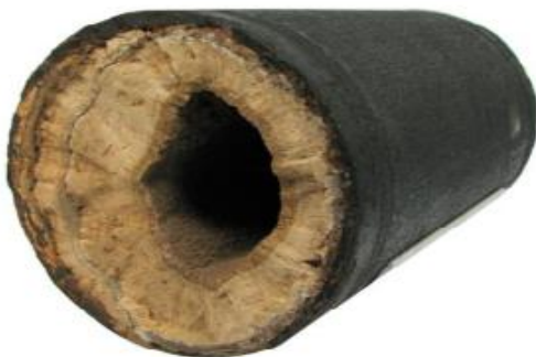
Hình 2. Tích tụ lắng đọng muối trong đường ống dẫn tới thiết bị xử lý dầu thô (Đỗ và nnk., 2010).
