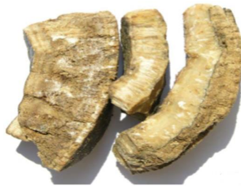
Hình 3. Lắng đọng muối lấy từ mỏ Bạch Hổ (Đỗ và nnk., 2010).
