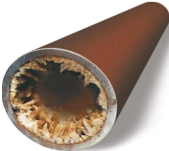
Hình 4. Lắng đọng muối trong ống khai thác (Tubing) (Đỗ và nnk., 2010).
